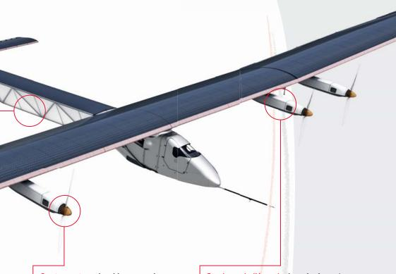
**Quatre moteurs** brushless sensorless de 17,4 V chacun (13,5 kw) fixés sous les ailes, munis d'un réducteur limitant à 525 tours/minute la rotation d'une hélice bipale de 4 m de diamètre.
