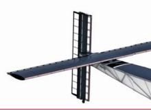
**17 248 cellules** en silicium monocristallin de 135 microns (plus fines qu'un cheveu humain) sur les ailes, le fuselage et le stabilisateur horizontal, présentant le meilleur compromis entre légèreté, flexibilité et rendement (23 %).
